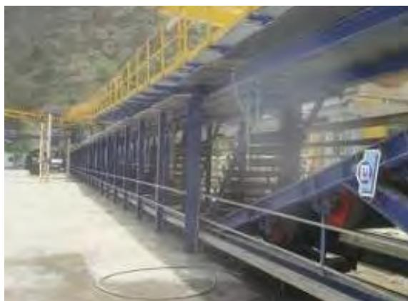
شکل (۴): مخزن نوار نصب شده در پروژه توول زاگرس
