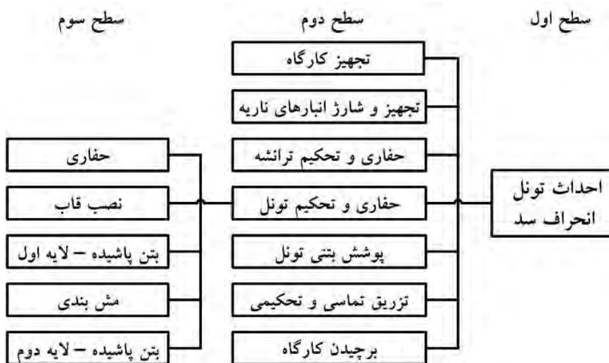
شکل ۲- ساختار تقسیم بندهی کار (WBS) یک پروژه تونل انحراف سد
