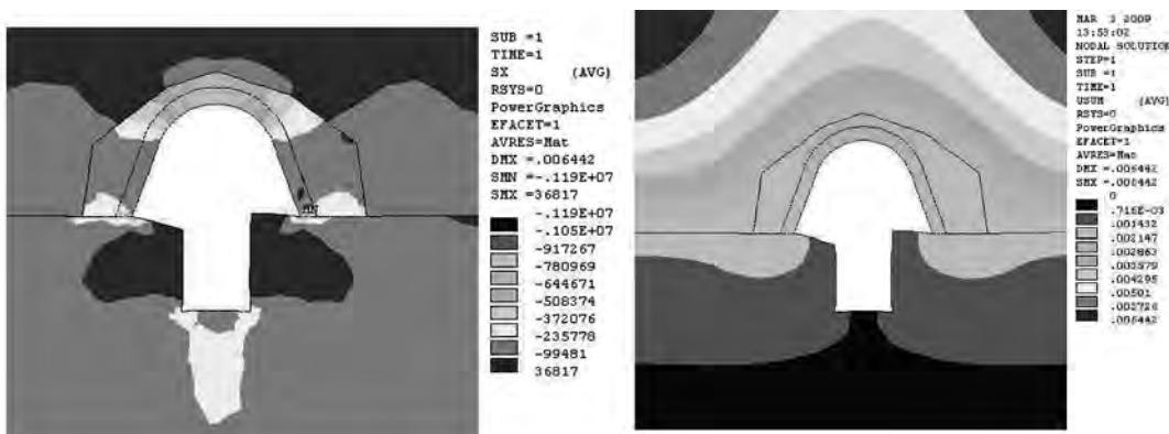
شکل ۶: توزیع تغییر شکل پلاستیک و تنش اصلی پلاستیک SX در مدل اندرکنشی
