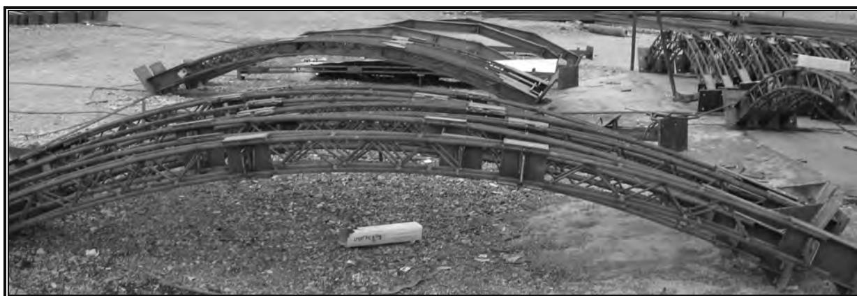
شکل ۷- نمونه‌ای از سیستم نگهداری فولادی مشبك که به عنوان نگهداری موقت به کاربرده می‌شود.
