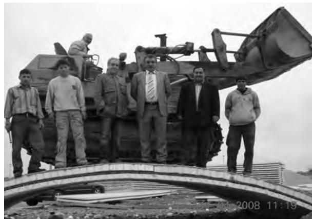
شکل ۱- نمونه‌ای از پانل‌های سه بعدی برای پوشش تونل و قابلیت باربری جالب آن
