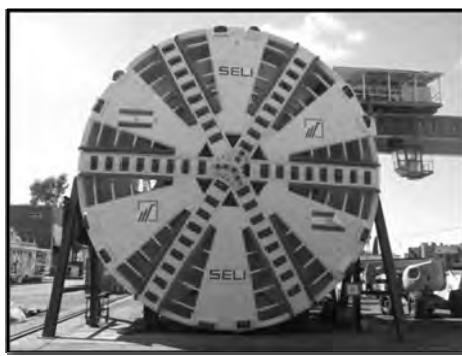
شکل ۲. نمای کاترهد دستگاه TBM خط ۷ مترو تهران
