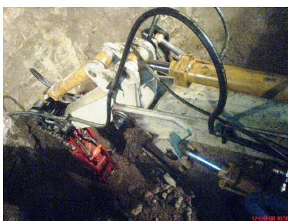
شکل ۷- چکش هیدرولیکی نصب شده بر روی بازوی دو منظوره طراحی و ساخته شده جهت حفاری در سنگ و ادامه مسیر
