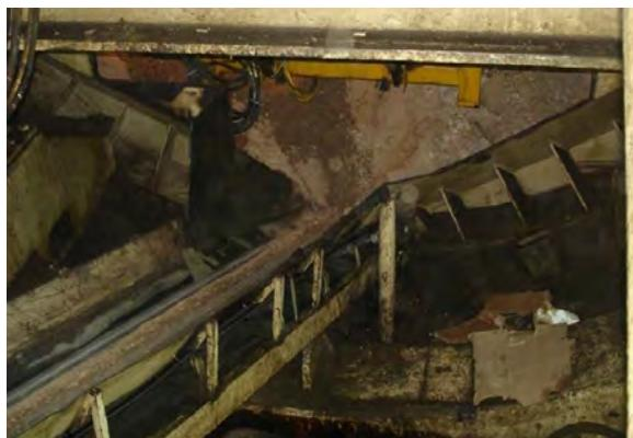
شکل ۱۵- سیستم تخلیه مصالح با استفاده از نوار نقاله
