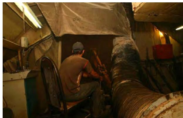
شکل ۹- سیستم راهبری دستگاه حفار زوکور
